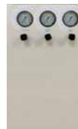
I manometri verificano e danno la possibilità di aumentare o diminuire la pressione dei cilindri della morsa.
